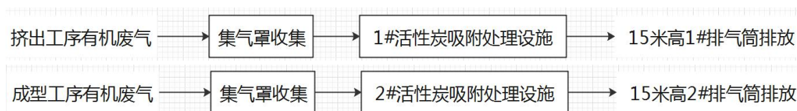
图3.2-1 有机废气处理工艺
